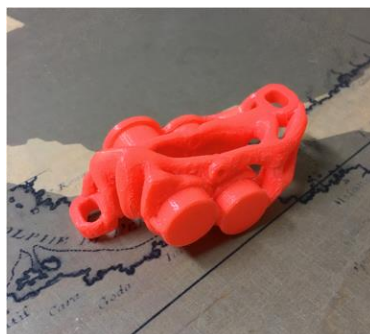
Etrier de frein en optimisation topologique pour une écurie de course
